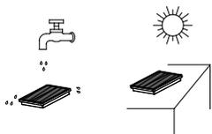
Почистите фильтр щеткой. При сильном загрязнении промойте его прохладной водой под краном. Запрещается мыть фильтр горячей водой или использовать для его мытья моющие средства. Запрещается стирать фильтр в стиральной машине.
