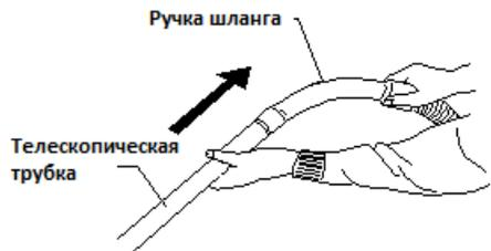
2. Соедините телескопическую трубку с ручкой гибкого шланга.
